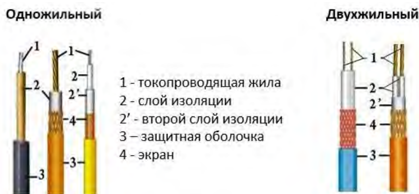
Рисунок 2 – Конструкция резистивных кабелей
