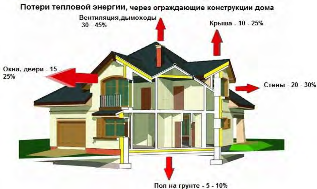
Рисунок 2 – Потери тепловой энергии через ограждающие конструкции домов
