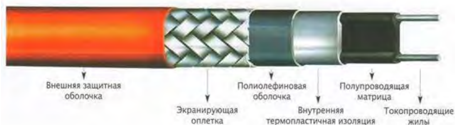
Рисунок 3 – Конструкция саморегулирующегося кабеля
