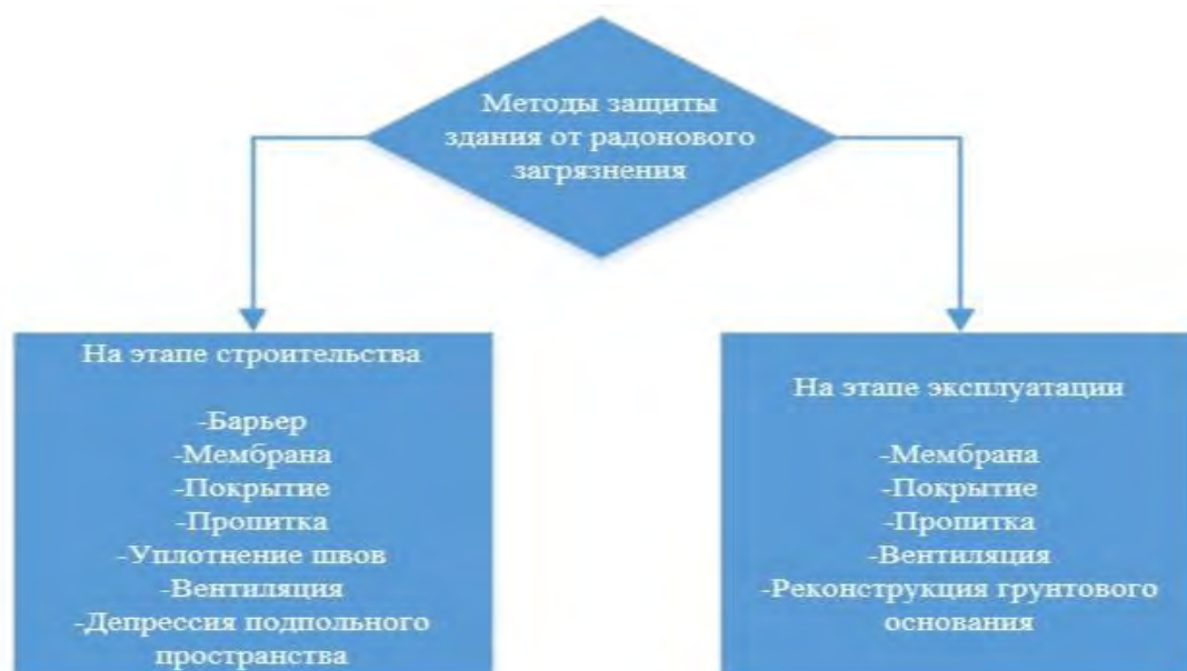
Рисунок 2 – Методы защиты от радонового загрязнения
