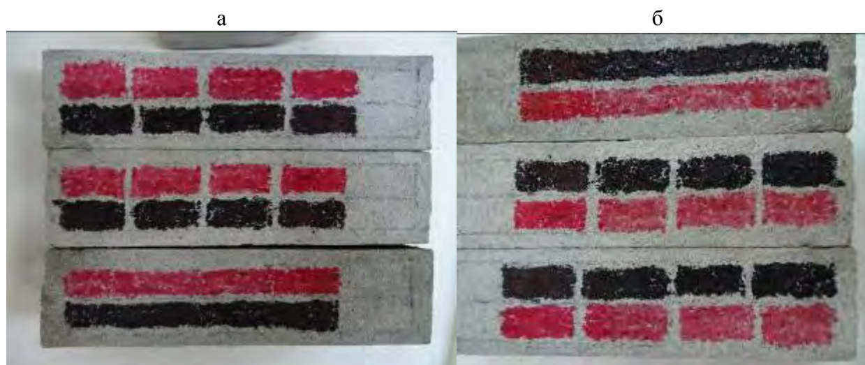
Рисунок 2 – Вид поверхности строительного раствора до УФ облучения (а) и после УФ облучения (б).
