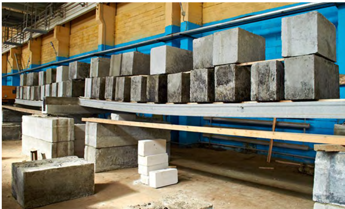
Рисунок 1 – Стенд испытания узла опирания под нагрузкой
