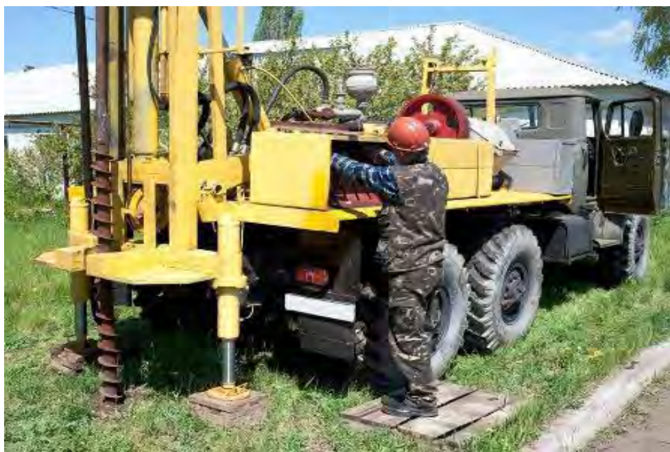
Рисунок 2 – Буровая установка УРБ 2А2 на базе автомобиля ЗИЛ-131
