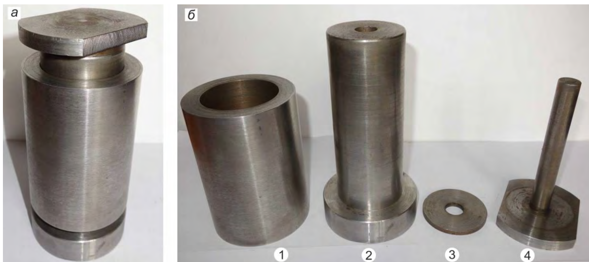
Рисунок 1 – Пресс-форма для прессования пустотелых керамических образцов в собранном виде (а) и основные элементы пресс-формы (б): 1 – цилиндрическая матрица; 2 – полый пуансон; 3 – шайба основания для съема образца; 4 – плита-основание матрицы со штоком
